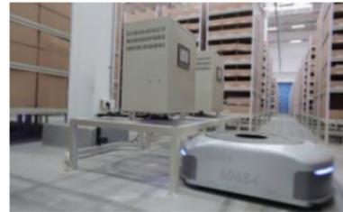
机器人采用安全性好、无污染的锂电池组供能。并自主研发充电站，实现充电10分钟工作2小时的快速充电，以及充电状态的监控和保护。
